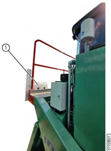
Fig. 15: Réservoir du liquide lave-glace
