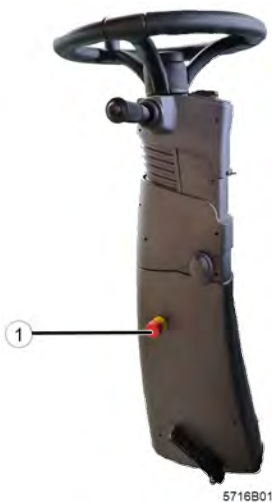
Fig. 49: Emplacement de l'arrêt d'urgence
