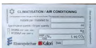
Fig. 133: Autocollant avec informations sur l'air conditionné
