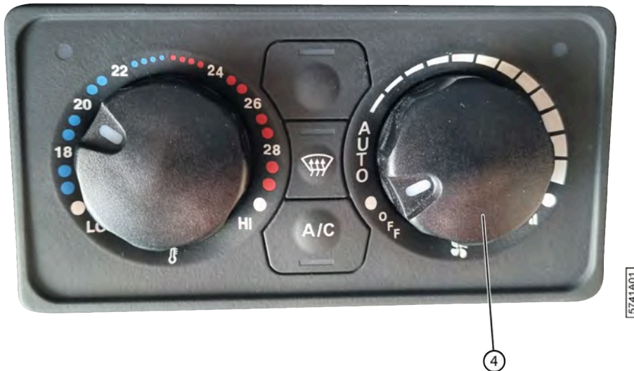
Fig. 104: Éteindre la climatisation
