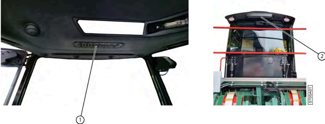
Fig. 161: Filtres à air de la cabine
